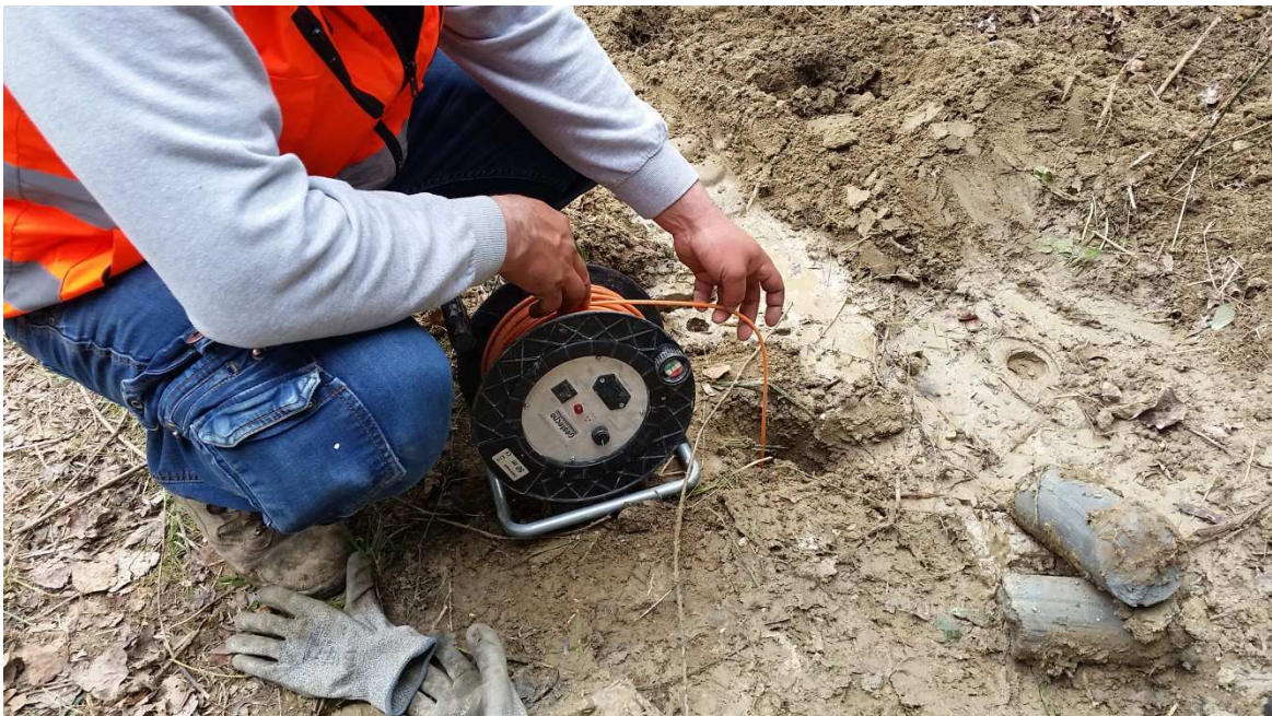
Foto n°4- Misurazione piezometrica in foro di sonda ggio.
