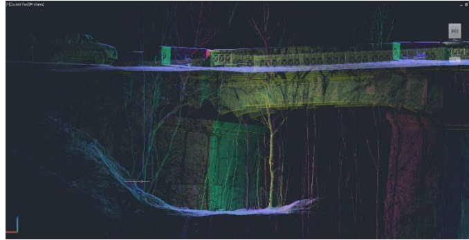
Figura 6: Particolare Nuvola di punti della spalla dx del Ponte N° 126.
