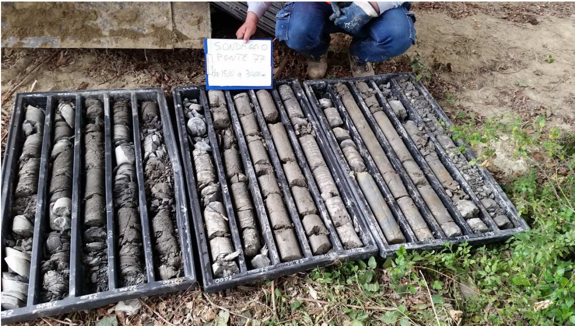
Foto n°7- Carote estratte dal sondaggio geognostico S77. Lettura da sinistra verso destra. Profondità indagine da 15 a 30 m.
