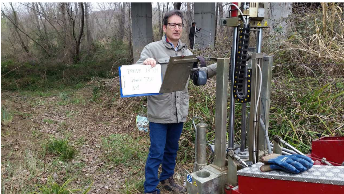
Foto n°2-Prova penetrometrica dinamica DPSH n°1.
