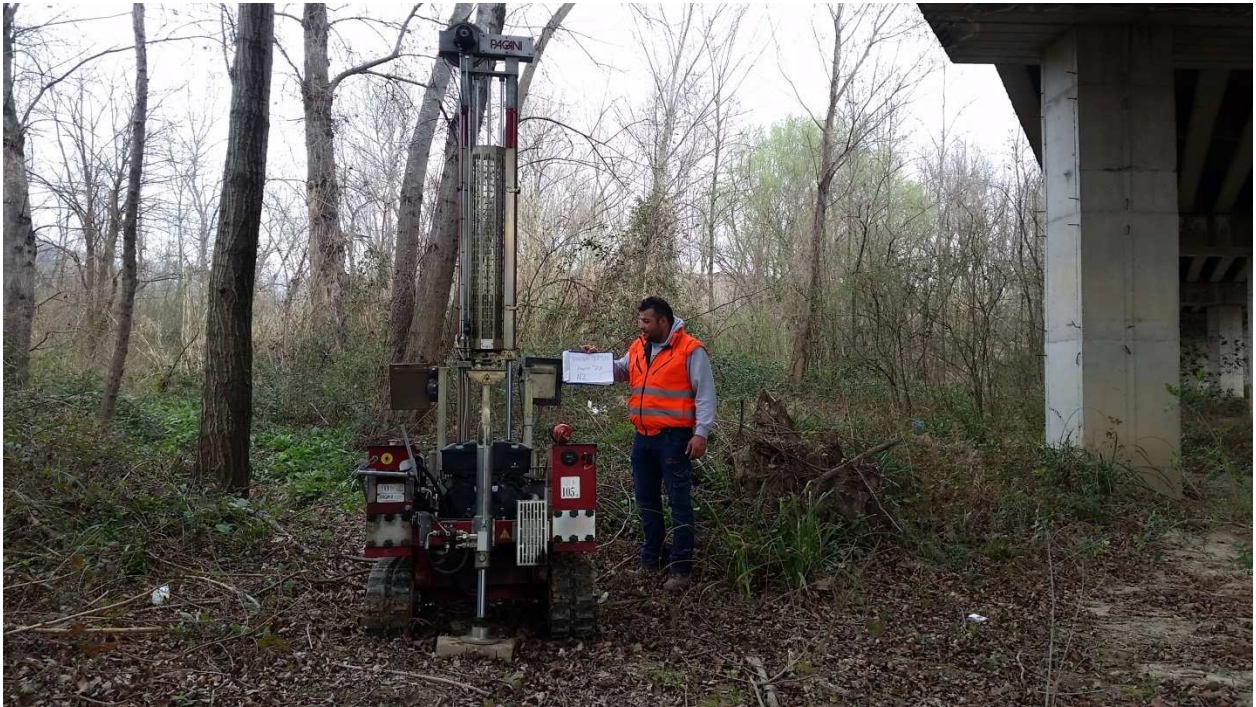
Foto n°3-Prova penetrometrica dinamica DPSH n°2.
