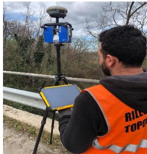
Figura7: Laser scanner FARO X 330 con sovrapposto gnss TRIMBLE R8S
